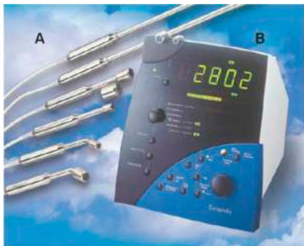
Figura 2.- Sonda de detección Gamma (Gamma probe) A) sondas de detección intraoperatoria de varios modelos, incluso para cirugía laparoscópica. B) panel de control con escalímetro digital, sonido de alarma y controles para seleccionar diferentes umbrales de conteo y rangos de energía, según el isótopo en uso (22).
